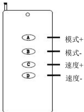
1.控制器和遥控出厂时已经对好码了，都贴好“对码标签”如下图:ID:1384，对好码的遥控只能对这一台控制器单独使用。遥控不可以对没贴“对码标签”的控制器使用，当遥控对不同标签的控制器使用时 我们需重新对码如上图：**控制器上电前 3 秒同时遥控按住 A、D 键 对码**，就可以使用了。
